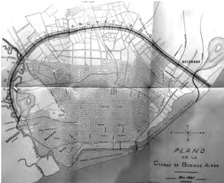
Figura 3.27: Proyecto de canal de circunvalación para la Ciudad de Buenos Aires. Autores: Blot y Ebelot (1887). Fuente: Departamento Nacional de Higiene (1904): 338a.
