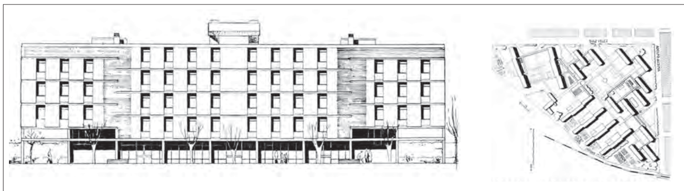
► EN LOS MONOBLOCKS PROYECTADOS POR HILARIO ZALBA EN AVELLANEDA, PCIA. DE BS. AS., LA PLANTA BAJA SE RESERVA PARA ACCESOS Y SERVICIOS.
