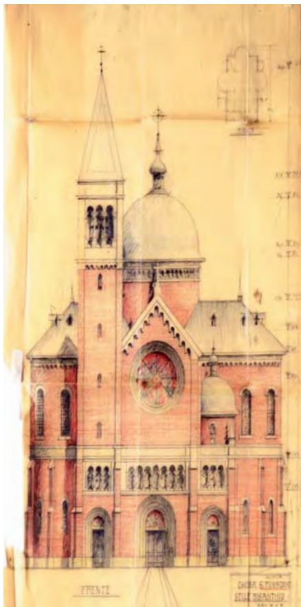
► FACHADA DE LADRILLO EN UN PROYECTO DE IGLESIA EN ESTILO ROMÁNICO, REALIZADO POR CESAR A. FERRARI.
