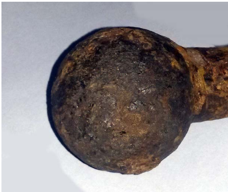
Fig. 2- Marca del molde en que fue fundida toda la pieza en dos mitades y luego unidas entre sí.
