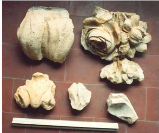
Molduras y ornatos de argamasa que decoraron la fachada de la casa Goyena. Proviene del escombros de su demolición usada como relleno del terreno del fondo para construir la Imprenta en 1884-85.
