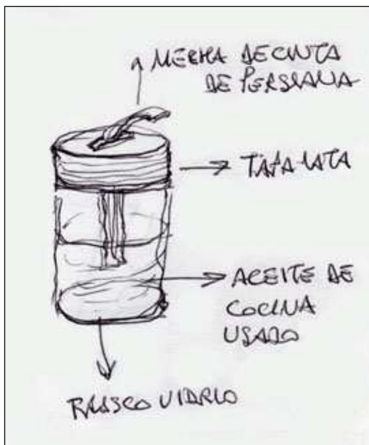
Figura 19. Sistema actual de iluminación que reproduce los mecanismos antiguos (observado en 2012, cuaderno de campo).
