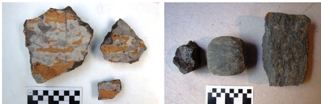
Fragmentos de revoque con tres colores de pintura a la cal y piedras utilizadas posiblemente para el alisado de las paredes.
