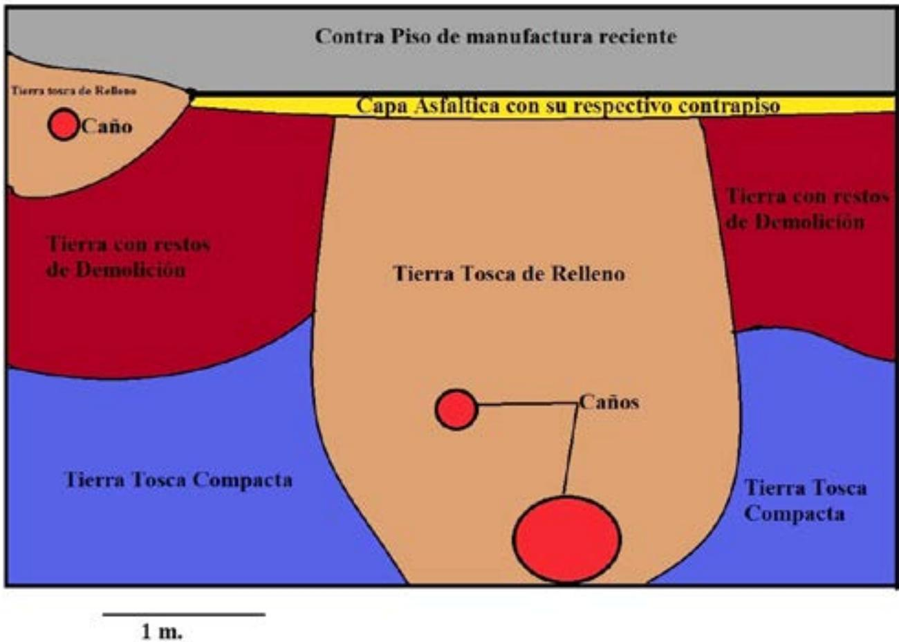
**Perfil 2.** Corte de la trinchera puede observar la vieja presencia de restos de asfalto de una calle de uso temporal y los caños de gas y electricidad que atraviesan la misma.
