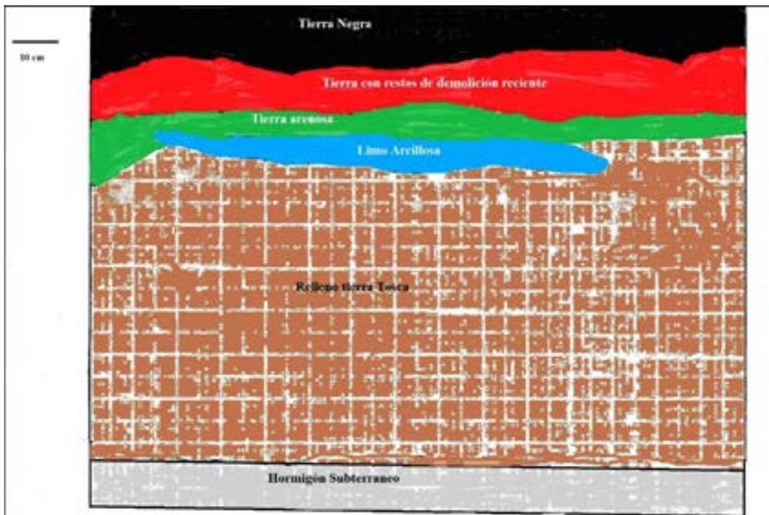
**Perfil 1.** Cuadrícula ampliada donde se notan los rellenos dispuestos con la realización del Subte C.
